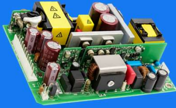
非對稱零電壓關斷(ZVS)反激式電路 300W PFC
