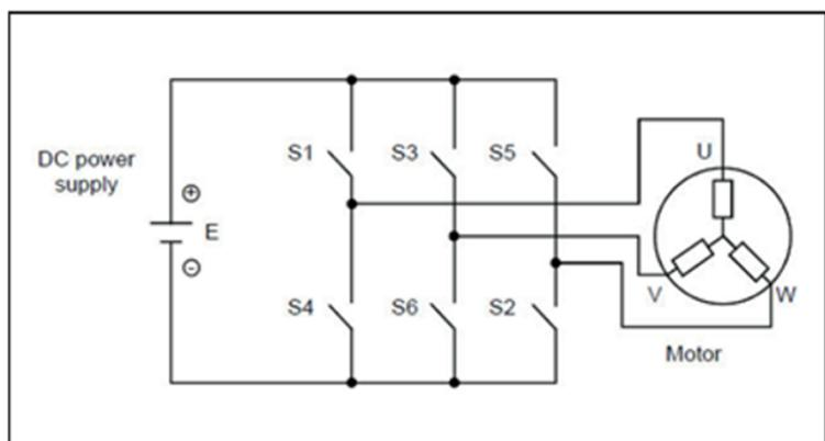
该拓扑结构基于六个电源开关，为电机提供电压，以控制其速度、位置或电磁转矩。每个半桥在具有连续负载电流的欧姆电感负载（电机）上以硬开关换向方式运行，每次换向都需要由与功率开关耦合的六个二极管完成续流阶段，以传导反向电流。
