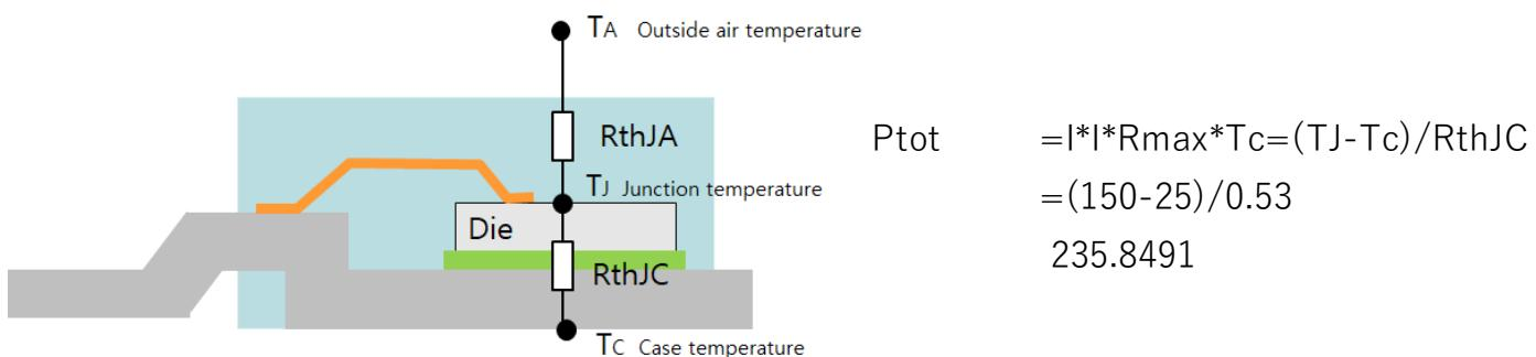
Fig.7 各温度点的定义以及如何计算功率耗散 PTOT。PTOT 可根据 RthJC 计算。
