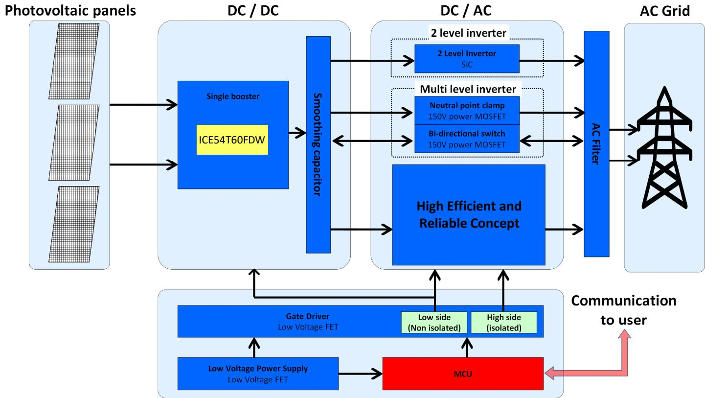
对于 DCDC，通常使用单个升压器；对于 DCAC，有三种 DCAC 块方法。
