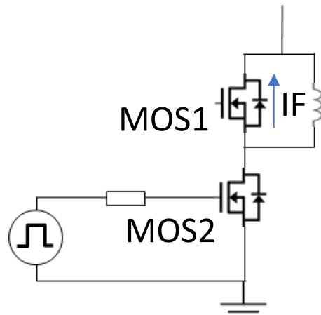
Fig.6 开关电路示例 当电流流过 MOS2，然后关闭时，中频电流流过 MOS1。当 MOS2 再次开启时，该电流流过 MOS2 时，MOS1 的体二极管的电压会升高。MOS1 的体二极管电压上升，显示出反向恢复操作，电流 电流波形如图 5 所示。电流波形如图 5 所示。
