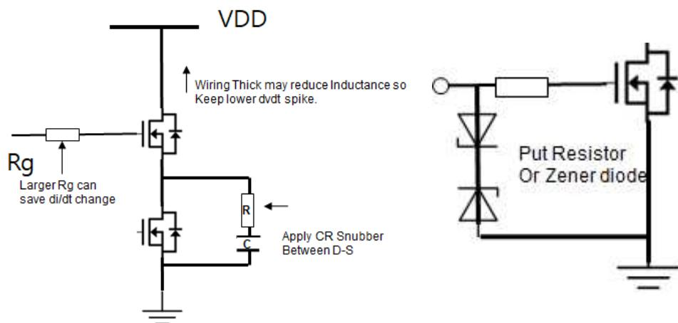
Fig.26 防止体二极管断裂的措施
