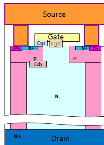
Fig. 19. SJMOSFET 结构的电容
