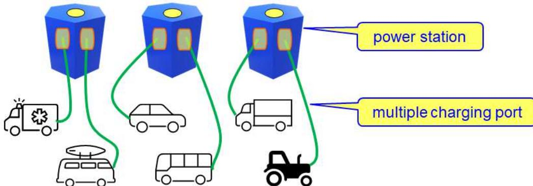
在同时为多辆电动汽车充电的充电站中，需要并联 15 千瓦至 30 千瓦的充电器，以输出 100 千瓦或更高的功率。我们目前正在开发的 GEN3 产品 ICE117T60 的 BVDSS 为 600V，采用 TO247 封装，可用于 15~30kW 系统。对于 100kW 超高速充电器而言，重要参数应为低  $R_{ds(on)}$  和  $P_d(W)$ 。
