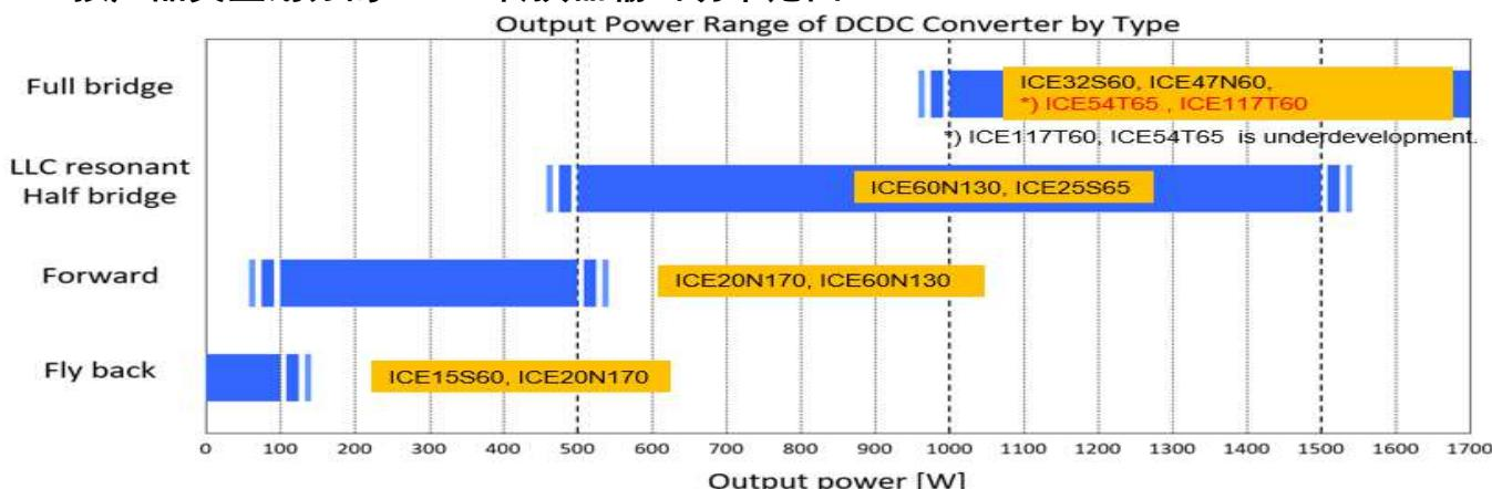
输出功率不同，电路选择也可能不同。全桥功率可能超过 1700W，因此请根据功率范围选择合适的产品。例如，对于 100W 反激式，我们提供最大电流为 20A 的 ICE20N170 或最大电流为 15A 的 ICE15S60。
