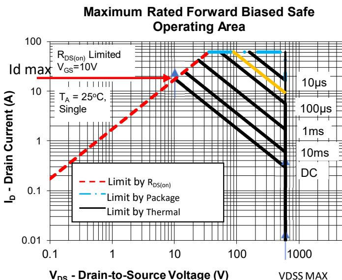
该图基于温度=25°C。说明 SOA 范围随着外壳温度  $T_c$  的升高而缩小。举例说明：脉冲=10μsec,  $T_c=75\text{degC}$  以估算 SOA
